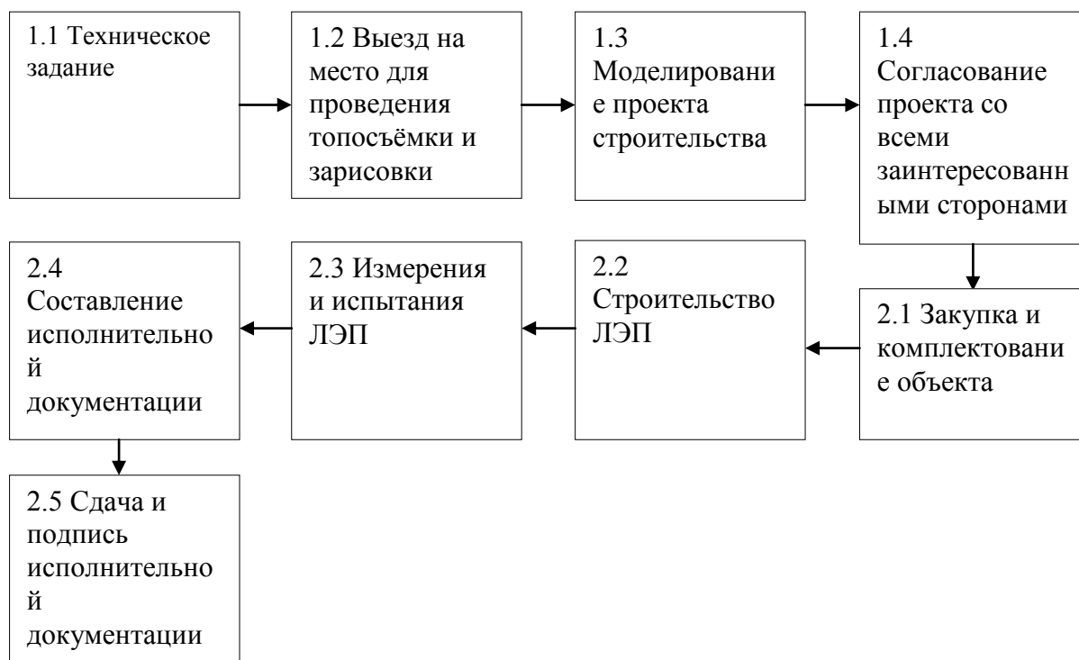
Рисунок 3 – Технология производственного процесса строительства ЛЭП
